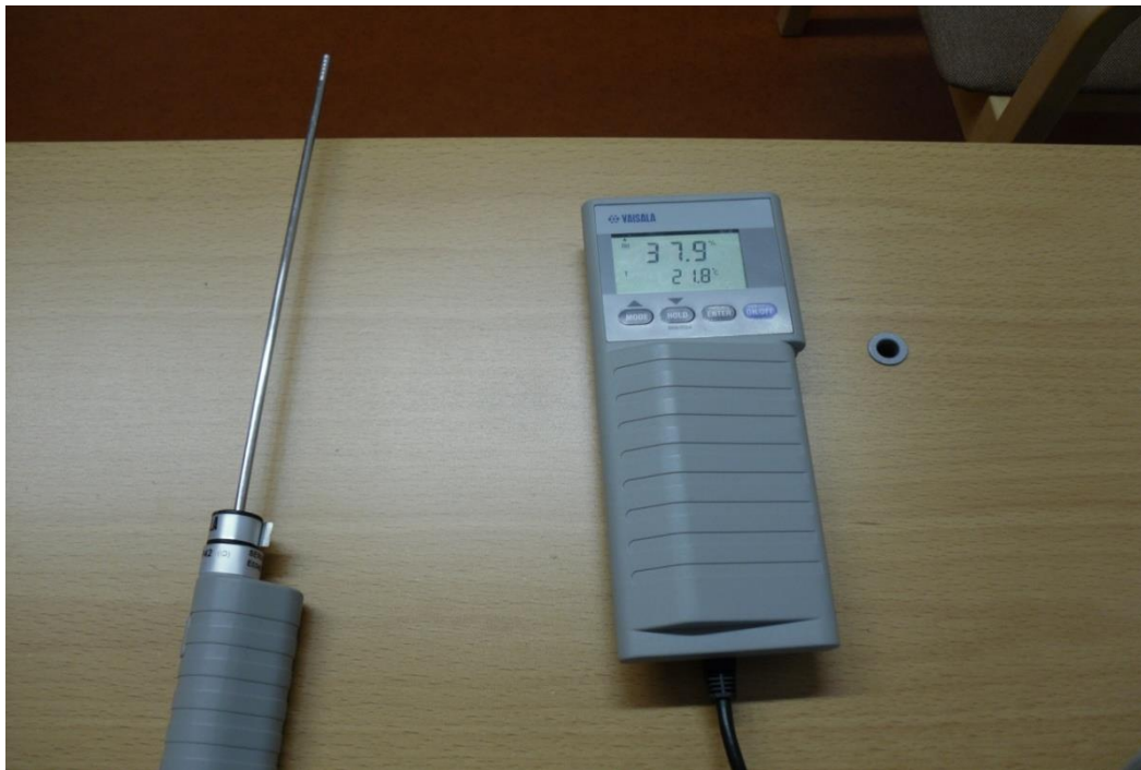
KUVA 7. Suhteellisen kosteuden (37,9) ja lämpötilan (28,8) mittaus Vaisalan HMI41 mittalaitteella ja mittapäällä HMP42. Valokuva Timo Tikkanen 2013
