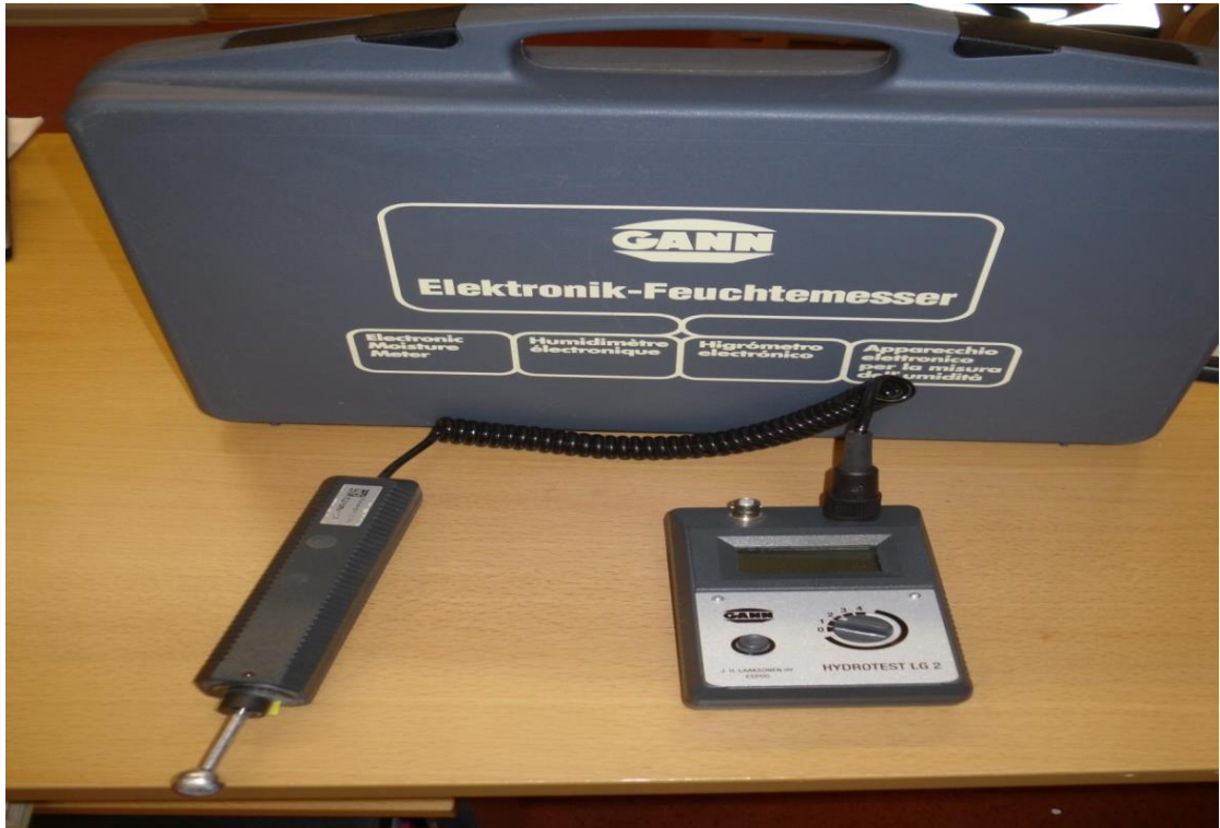
KUVA 4. GANN HYDROTEST LG 2 kosteudenosoitin ja pinta-anturi B 50. Valokuva Timo Tikkanen 2013
