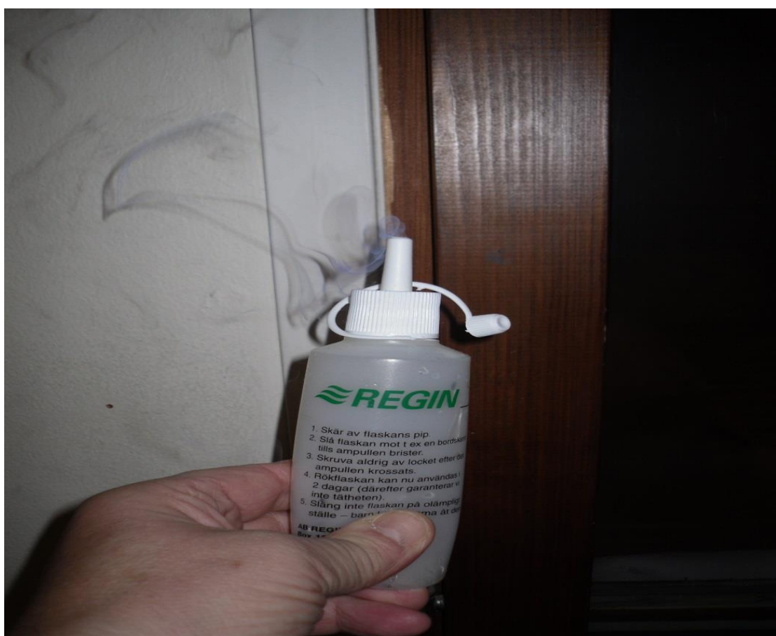
KUVA 6. Ilmavuotojen todentaminen Regin savupullon avulla. Valokuva Timo Tikkanen 2013
