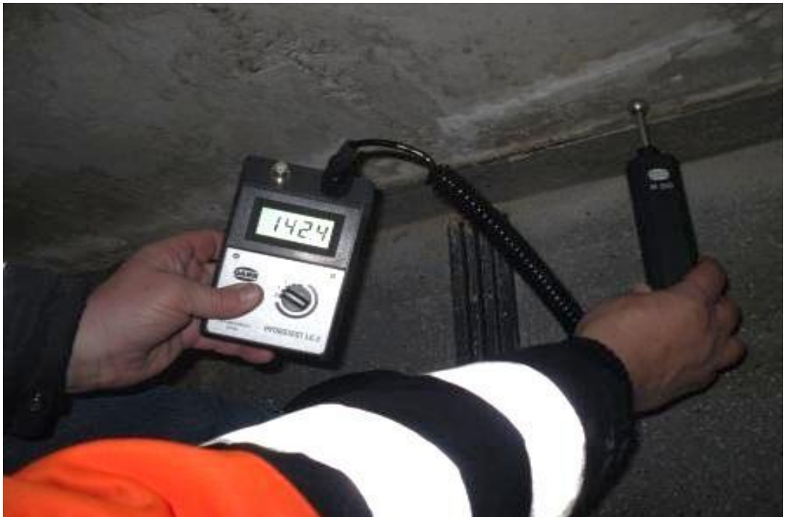
KUVA 5. Kosteuskartoitusta GANN HYDROTEST kosteudenosoittimella. Valokuva Timo Tikkanen 2013
